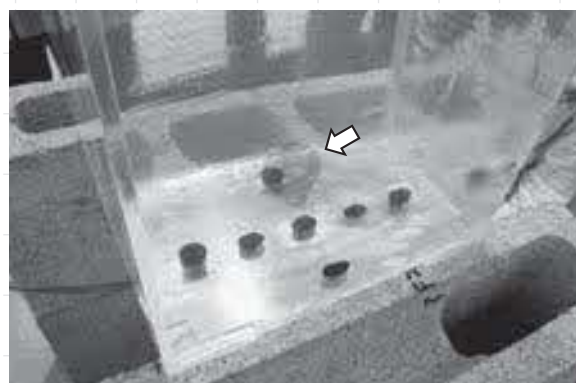
岩脈を作る実験。透明な箱の中は透明なゼリー。矢印のところがラー油。ゼリーが地下の岩石、ラー油がマグマの代わりに使われている。
